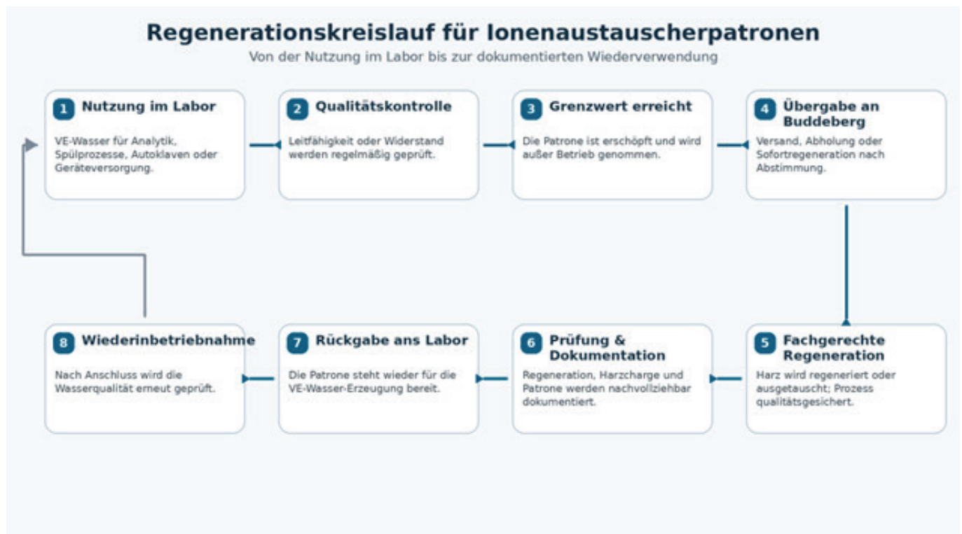
Abb. 1: Geschlossener Regenerationskreislauf für Ionenaustauscherpatronen - von der Nutzung im Labor bis zur dokumentierten Wiederverwendung.
